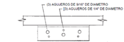
Detalle de la placa ángulo de soporte
